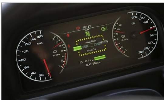
El panel muestra la batería restante y le avisa al chofer cómo manejar para no gastar energía demás.
